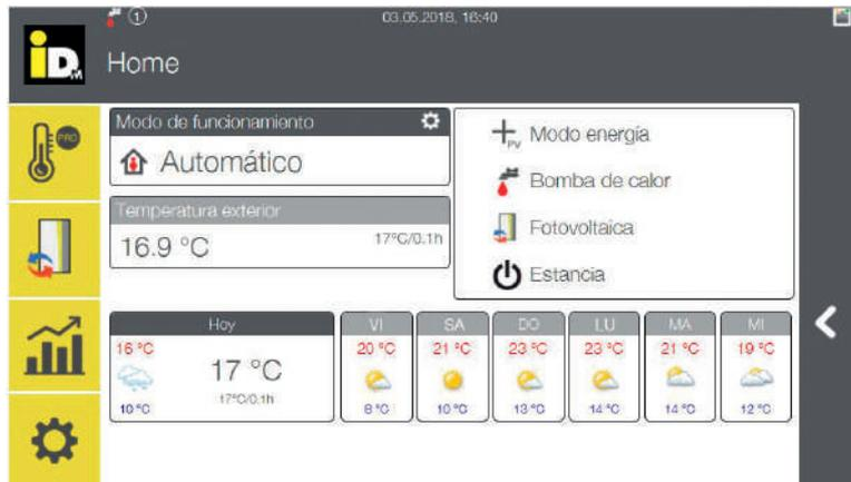
La previsión de horas de sol, temperatura exterior, provabilidad de lluvia, radiación solar, velocidad y dirección del viento son parámetros que el sistema tiene en cuenta para tomar decisiones.
