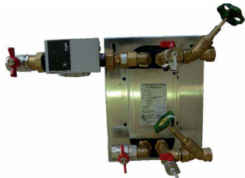
Lanza de intercambio térmico (1kW)
