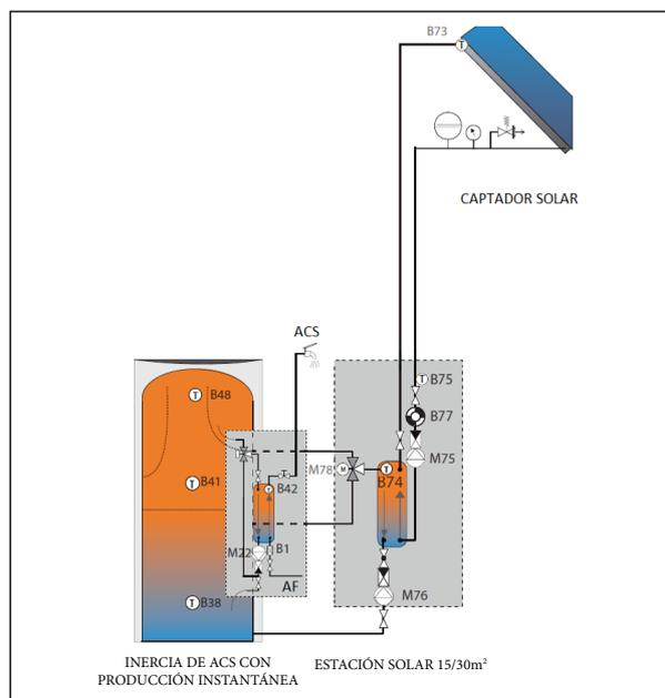
Estación solar hasta 15/30 m<sup>2</sup> con válvula desviadora para carga estratificada
