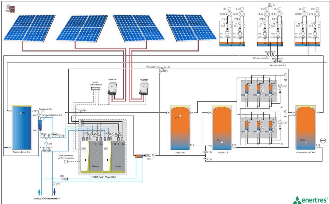
Sistema centralizado de geotermia en cascada con bomba geotérmica TERRA MAX DUO de 280 kW con sistema a cuatro tubos de producción simultánea de frío / calor y acs con dos sistemas independientes de producción instantánea de 210 l/min (producción total de 420 l/min) e integración fotovoltaica con Sistema Confort
