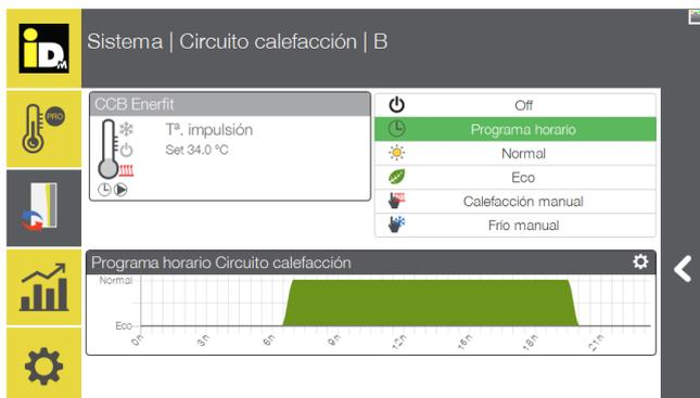
Podemos establecer dos temperaturas (Normal y Eco) para adaptar el funcionamiento de la instalación en cada modo de trabajo (frío-calor). Además podemos realizar una programación semanal por circuito.
