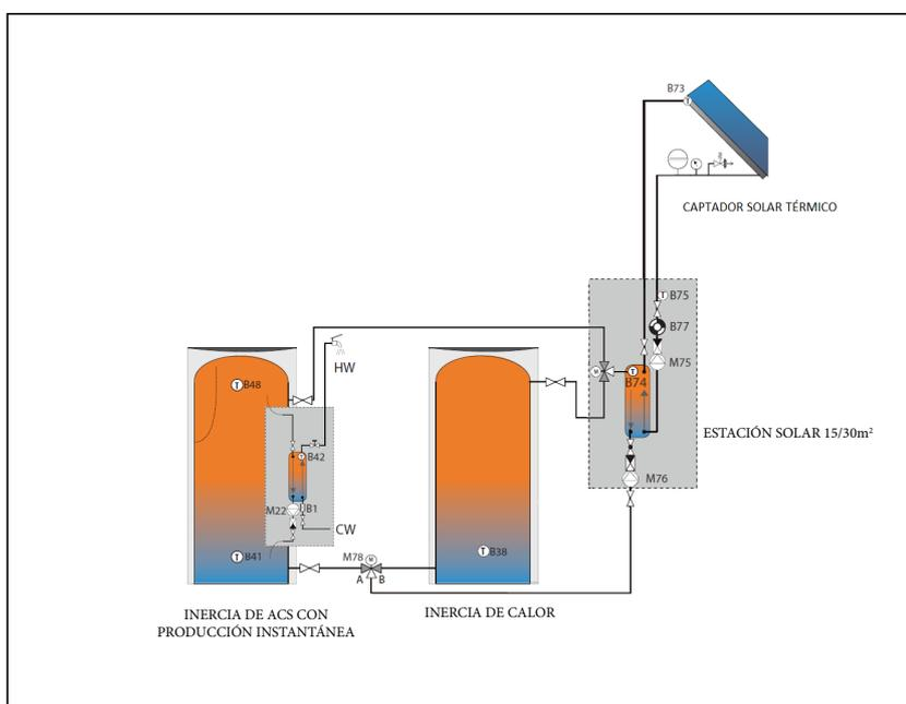
Estación solar hasta 15/30 m<sup>2</sup> con válvula desviadora para carga estratificada
