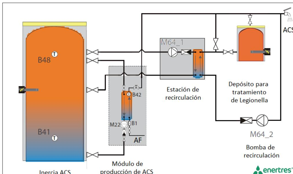
Para instalaciones centralizadas con producción de ACS instantánea que tengan que garantizar la posibilidad de realizar un tratamiento de esterilización antilegionella, ofrecemos la posibilidad de realizarlo mediante un reducido depósito, una resistencia eléctrica y un juego de válvulas de corte.
