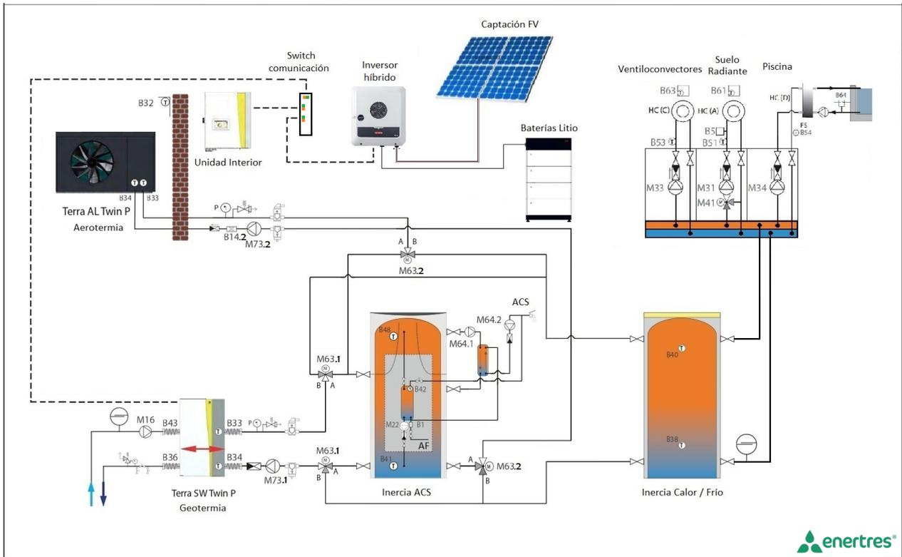
Sistema centralizado de aerotermia y geotermia en cascada una bomba geotérmica TERRA SW TWIN-P de 42 kW y una bomba de calor aerotérmica AL TWIN de 38kW (80 kW)
