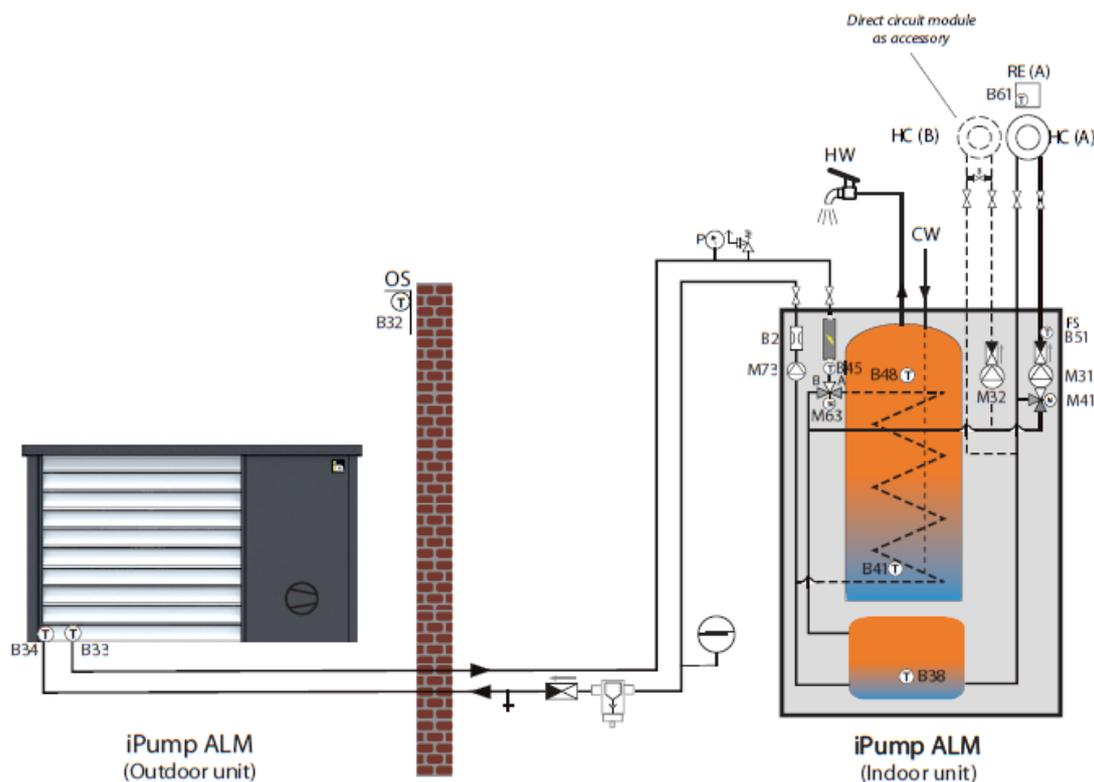
**AERO iPump ALM para ACS y calor y frío no simultáneo**
