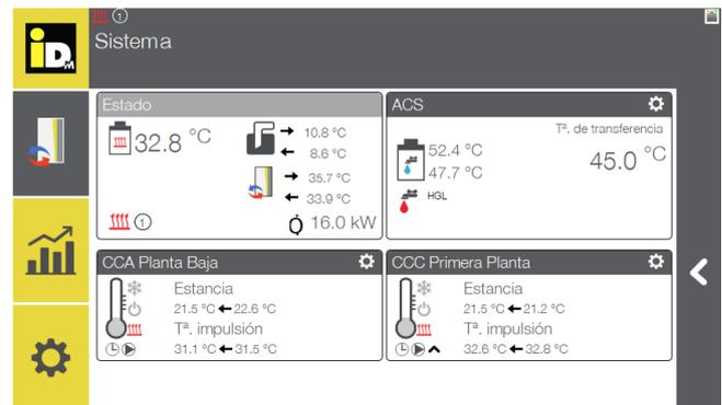
En la regulación Navigator 2.0 podemos acceder fácilmente al consumo eléctrico (sólo modulantes) correspondiente a la bomba de calor y a la energía calorífica producida en los diferentes modos de funcionamiento. Esta información la podemos visualizar para tener acceso al consumo y producción diarios, mensual, anual o total de la vida de la bomba de calor.
