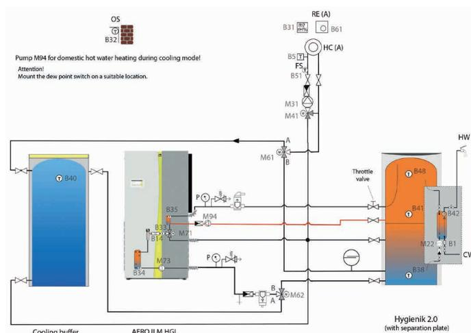
**Aero ILM HGL frío/calor con set de conexión ACS en modo frío para producción de ACS gratuita cuando tiene demanda de frío\***
