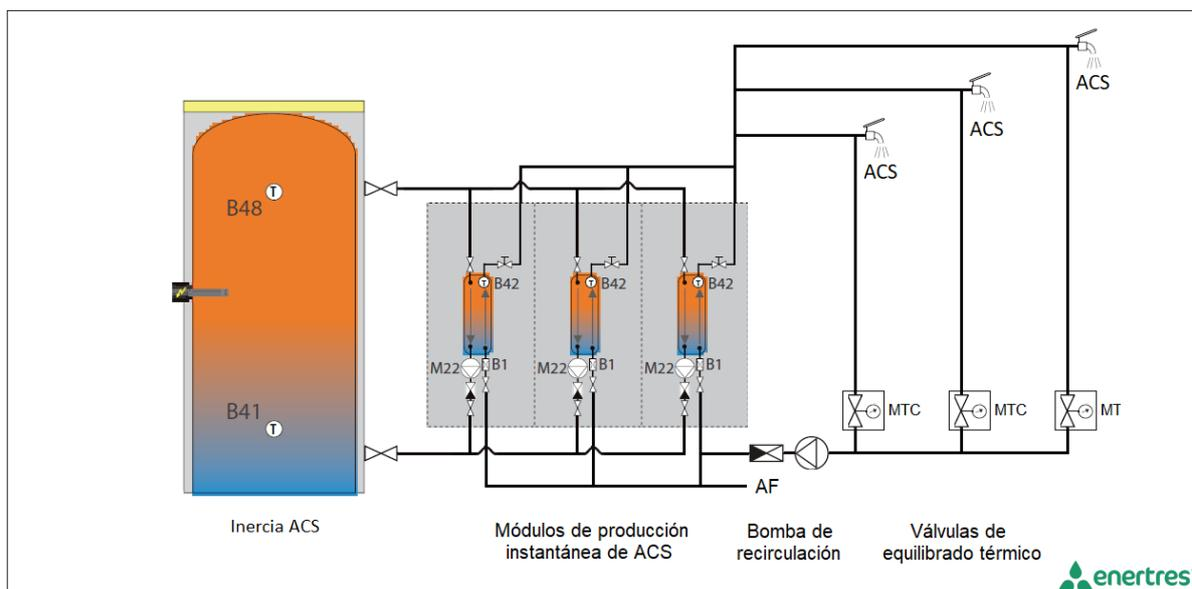
En instalaciones centralizadas con producción instantánea de ACS ofrecemos la posibilidad de realizar un equilibrado térmico mediante válvulas de cierre para optimizar la eficiencia de la instalación y garantizar el confort térmico en toda la distribución de ACS.
