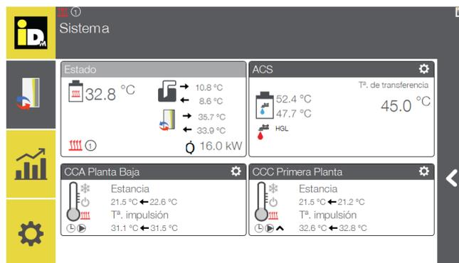
En la regulación Navigator 2.0 podemos acceder fácilmente al consumo eléctrico (sólo modulantes) correspondiente a la bomba de calor y a la energía calorífica producida en los diferentes modos de funcionamiento. Esta información la podemos visualizar para tener acceso al consumo y producción diarios, mensual, anual o total de la vida de la bomba de calor.
