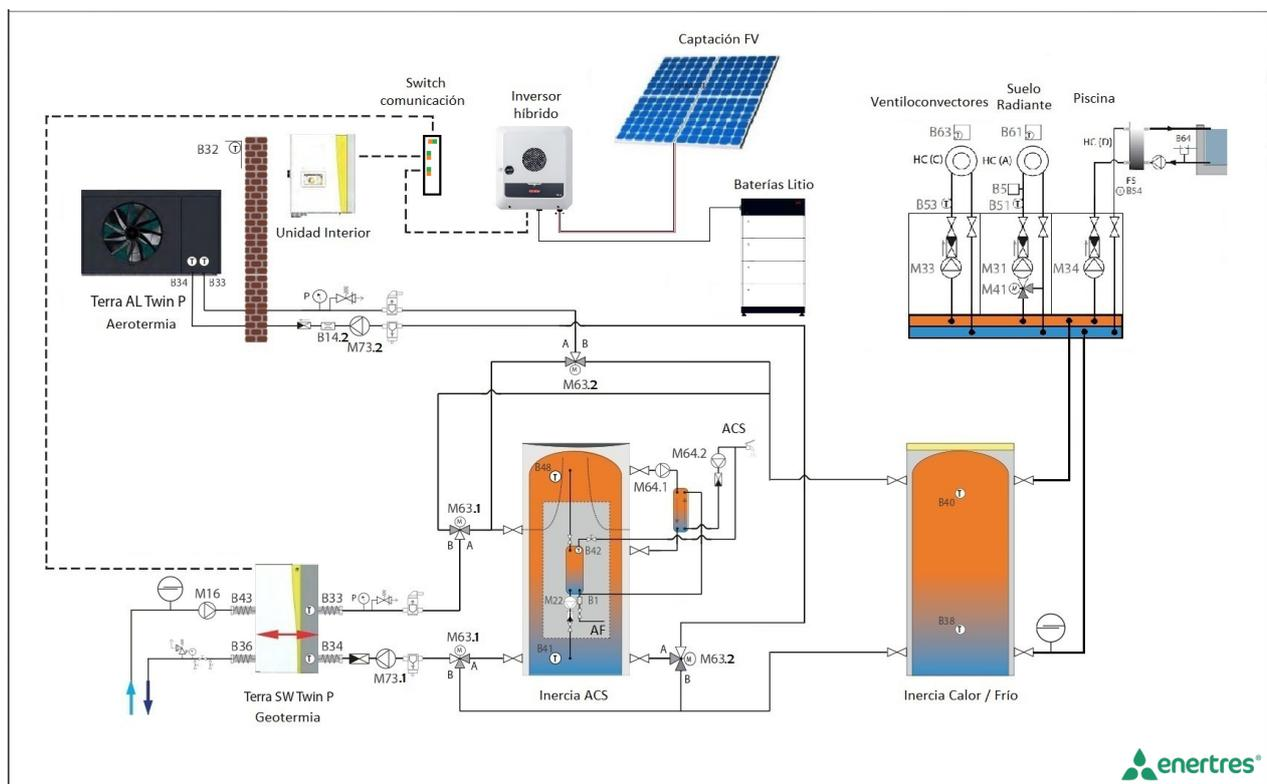
Sistema centralizado de aerotermy y geotermy en cascada una bomba geotérmica TERRA SW TWIN-P de 42 kW y una bomba de calor aerotérmica AL TWIN de 38kW (80 kW)
