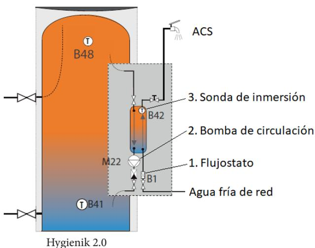
ESQUEMA DEL MÓDULO DE PRODUCCIÓN CON DETALLE DE FUNCIONAMIENTO
