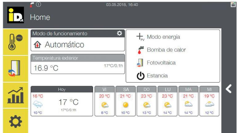
La previsión de horas de sol, temperatura exterior, probabilidad de lluvia, radiación solar, velocidad y dirección del viento son parámetros que el sistema tiene en cuenta para tomar decisiones.
