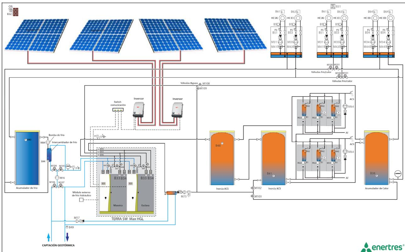
Sistema centralizado de geotermy en cascada con bomba geotérmica TERRA MAX DUO de 280 kW con sistema a cuatro tubos de
