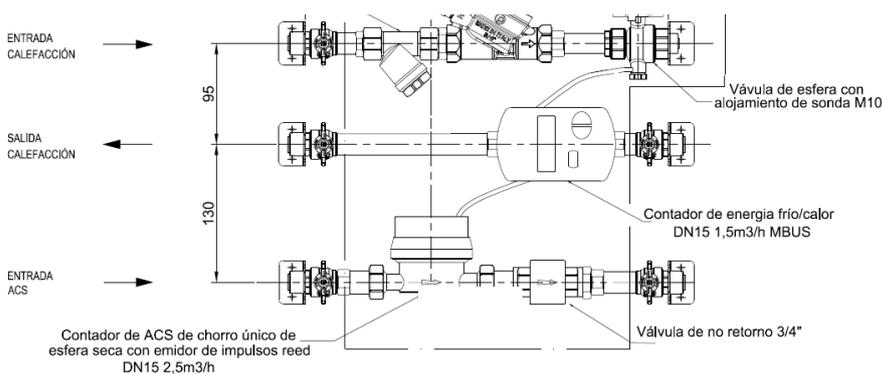
NOTA: Todas las conexiones de entrada y salida, así como los tramos de tubería intermedia son en 3/4"
