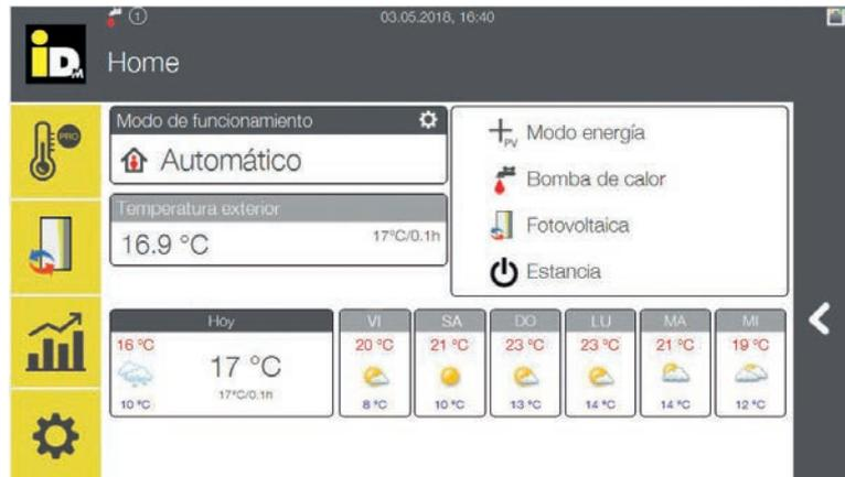
La previsión de horas de sol, temperatura exterior, probabilidad de lluvia, radiación solar, velocidad y dirección del viento son parámetros que el sistema tiene en cuenta para tomar decisiones.
