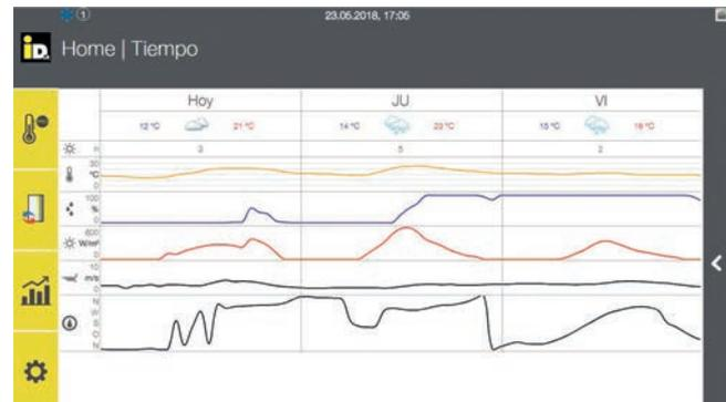
El sistema aporta un seguimiento completo del comportamiento del sistema fotovoltaico a través de la propia pantalla de la bomba de calor y de la APP (Android e IOS) ofreciéndonos estadísticas en tiempo real, por día, mes o año y por otro lado el sistema permite el establecimiento de temperaturas máximas de consigna para el aprovechamiento fotovoltaico en función de los elementos instalados.
