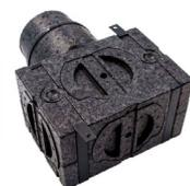
Kit plenum universal en ABS con manguitos en polipropileno que proporciona conexión con tubo corrugado. Posibilidad de ajuste caudal a través de amortiguadores especiales insertables dentro; inserción filtro opcional.
