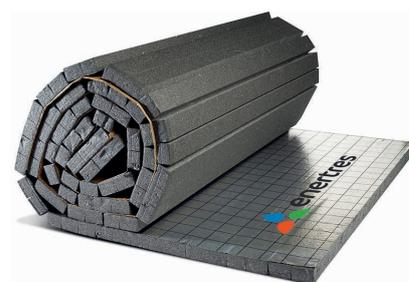
Panel de EPS y **grafito** en rollo con **cubierta difusora de aluminio y lamina de alisamiento acustico**. Solapas adhesivas laterales de 30 mm para la unión de los paneles que propician la continuidad del aislante.
