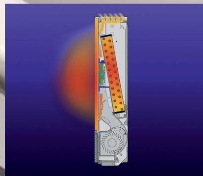
En particular, durante el período de calefacción EnerFit RD combina el efecto de calentamiento por convección del ventilador con el efecto de radiación del panel frontal, con lo que se consigue incrementar su rendimiento y la sensación de bienestar.
