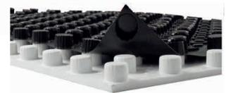
Panel EPS (Enertech 42 y 52) y panel EPS más grafito (Enertech 62 Graphite) plastificado y moldeado con marcado CE y fabricado según la Norma EN 13163, con film rígido. Ofrece un excelente aislamiento térmico y un óptimo comportamiento ante amortiguación de impactos. Específicamente diseñado para la instalación de sistemas de calefacción por suelo radiante. Compatible únicamente con tubo de 16 mm.
