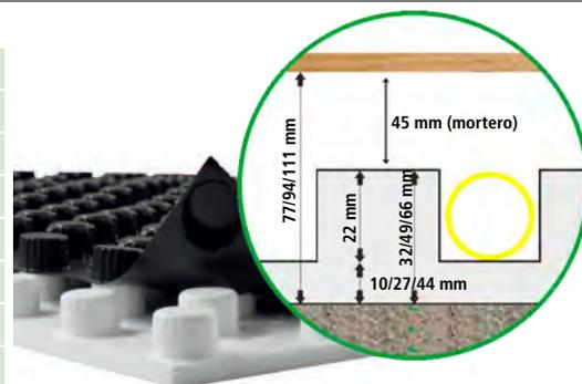
Panel de Poliestireno expandido EPS - AU termoconformado rígido con marcado de superficie moldeada y laterales machi-hembrados. Ofrece un excelente aislamiento térmico y un óptimo comportamiento ante reducción sonora al impacto. Diseñado para la instalación de sistemas de calefacción por suelo radiante térmico y refrescamiento. Compatible con tubo de 16 mm y 17 mm.
